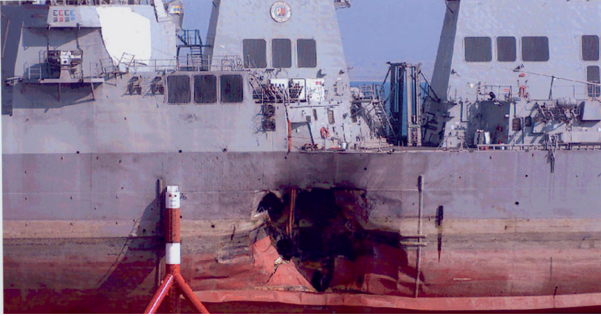
Şekil-1: Saldırı sonrası USS Cole muhribinde oluşan hasar 19
